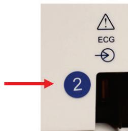
Uma etiqueta circular com número 2 na estrutura traseira do eletrocardiógrafo ELI, localizada junto ao conector de entrada ECG, indica que o eletrocardiógrafo contém internamente uma UTK versão 2.
