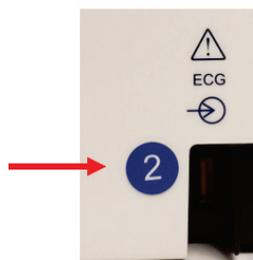
Un'etichetta circolare con il numero 2 sull'alloggiamento posteriore dell'elettrocardiografo ELI, situata accanto al connettore di ingresso ECG, indica che l'elettrocardiografo contiene internamente un'etichetta UTK versione 2.
