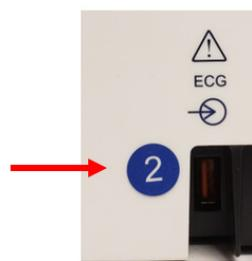
Круглая метка номер 2 на задней панели электрокардиографа ELI, расположенная рядом с входным разъемом ЭКГ, указывает на то, что электрокардиограф имеет внутреннюю версию UTK 2.
