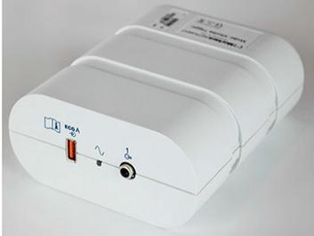
O cabo do paciente do XScribe AM12 deve ser conectado ao conector USB do ECG A na parte frontal do módulo. Uma conexão de saída analógica (↻ 1) também está na parte frontal do módulo de disparo.
