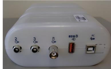
A parte posterior do módulo inclui dois conectores de saída analógica não funcionais (2 e 3) e um conector de saída TTL (TTL).
