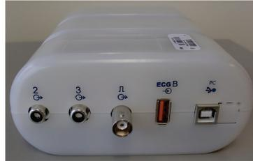
A parte posterior do módulo tem dois conectores de saída analógica (atualmente ↻ 2 e ↻ 3 não são funcionais) e uma conexão de saída TTL (↻ π).
