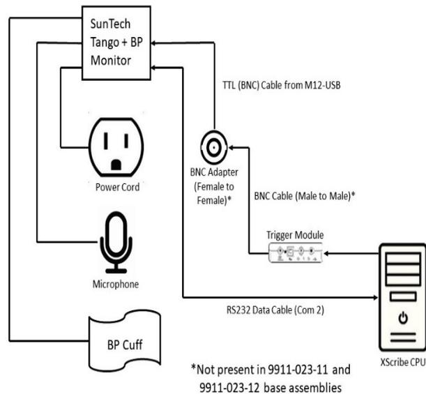
1. Connectez le câble RS-232 (référence SunTech 91-0013-00) au connecteur 9 broches sur le panneau arrière du Tango+, et l'autre extrémité au port COM 2 à l'arrière de l'unité centrale XScribe.
