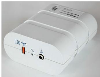
Le câble patient XScribe AM12 doit être connecté à un connecteur USB ECG A situé à l'avant du module de déclenchement. Une connexion de sortie analogique active ( $\odot \rightarrow 1$ ) se trouve également à l'avant.
