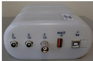
L'arrière du module comprend deux connexions de sortie analogique non fonctionnelles ( $\odot \rightarrow 2$  et  $\odot \rightarrow 3$ ) et une connexion de sortie TTL ( $\square \rightarrow$ ).
