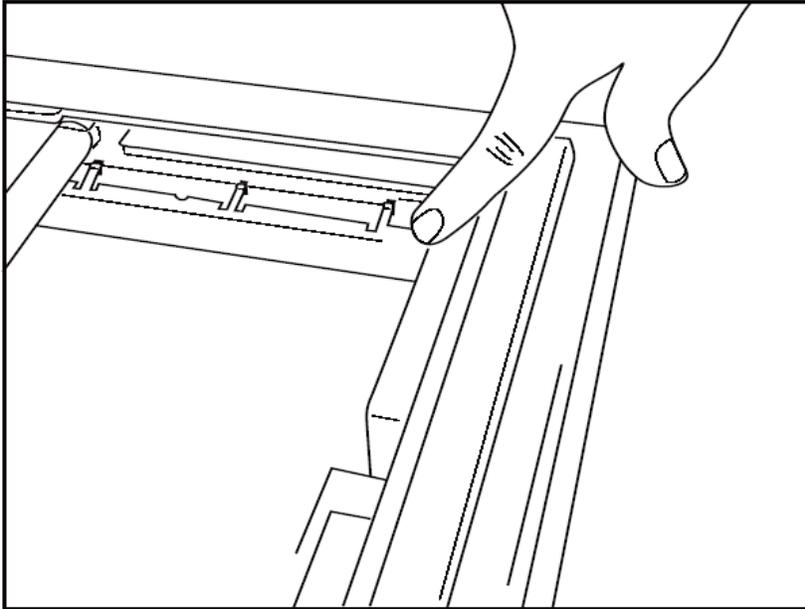
2. L'écarteur du bac à papier doit être parallèle à la paroi arrière du bac de l'imprimante, comme illustré ci-dessus.
