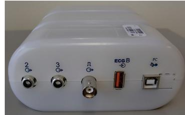
L'arrière du module fournit deux connexions de sortie analogique (2 et 3 ne sont actuellement pas fonctionnels) et une connexion de sortie TTL (TTL).
