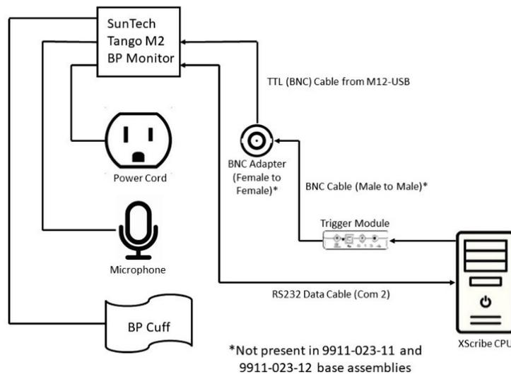
1. Connectez le câble RS-232 (référence SunTech 91-0013-00) au connecteur 9 broches sur le panneau arrière du Tango M2, et l'autre extrémité au port COM 2 à l'arrière de l'unité centrale XScribe
