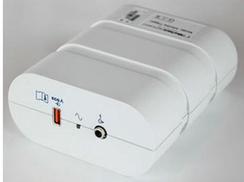
Le câble patient XScribe AM12 doit être connecté à un connecteur USB ECG A situé à l'avant du module. Une connexion de sortie analogique (1) se trouve également à l'avant du module de déclenchement.
