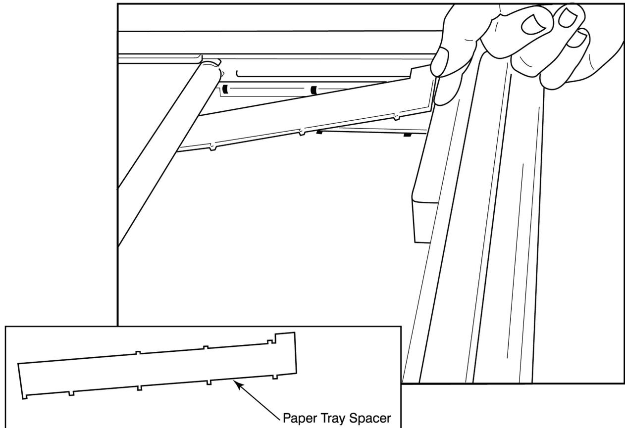
1. Faites glisser l'écarteur du bac à papier vers la paroi arrière du bac de l'imprimante. Alignez les quatre bras en plastique inférieurs avec les quatre ouvertures de la base du bac de l'imprimante. De même, alignez les 3 bras en plastique supérieurs avec les trois ouvertures sur la paroi arrière du bac de l'imprimante.
