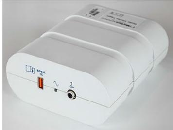
Das XScribe AM12 Patientenkabel muss an den EKG-A USB-Steckverbinder an der Vorderseite des Triggermoduls angeschlossen werden. Ein aktiver Analogausgang-Steckverbinder (↻1) befindet sich ebenfalls auf der Vorderseite.
