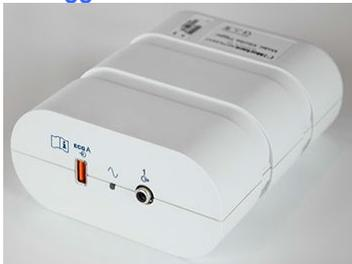
Das XScribe-AM12-Patientenkabel muss an den EKG-A-USB-Steckverbinder auf der Vorderseite des Moduls angeschlossen werden. Ein analoger Ausgangsanschluss (1) befindet sich ebenfalls auf der Vorderseite des Triggermoduls.
