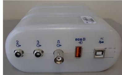
Auf der Rückseite des Moduls befinden sich zwei nicht-funktionale Analogausgang-Steckverbinder (↻2 und ↻3) und ein TTL-Ausgangsteckverbinder (π).
