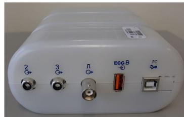
Auf der Rückseite des Moduls befinden sich zwei analoge Ausgangsanschlüsse (2 und 3 sind derzeit nicht funktionsfähig) und ein TTL-(π)Ausgangsanschluss.
