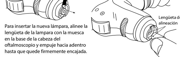
Para insertar la nueva lámpara, alinee la lengüeta de la lámpara con la muesca en la base de la cabeza del oftalmoscopio y empuje hacia adentro hasta que quede firmemente encajada.
