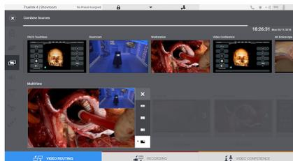
Dans la section multivue, il est possible de créer une composition de 2 ou 4 images parmi celles disponibles dans la liste des sources. Sélectionnez la disposition souhaitée : image dans image (PiP), image et image (PaP), image sur image (PoP) et quadruple image (Quadriview). Puis, remplissez la composition en faisant glisser, les unes après les autres, les images des sources et en les déposant dans les cases correspondantes.
