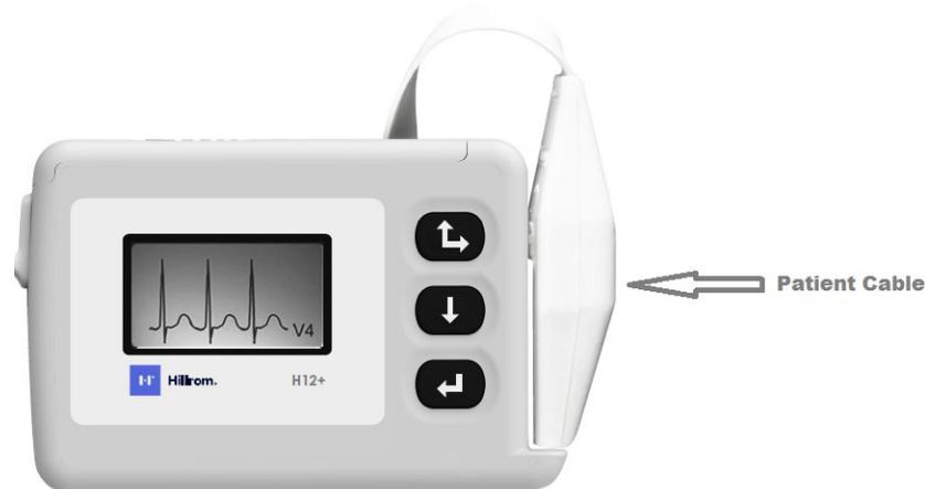
Der H12+ Rekorder verwendet eine einzige AA-Alkali-Batterie, um kontinuierliche 12-Kanal-Datenaufzeichnungen zu liefern, und eine entnehmbare sichere digitale (SD-)Karte zur Datenspeicherung.
