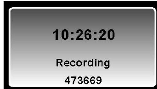
Während des normalen Betriebs einer Standard-48-Stunden-H12+ Aufnahme wird die aktuelle Uhrzeit (HH:MM:SS) während der gesamten Aufzeichnungssitzung in der Mitte des Bildschirms angezeigt. Die Summe der aufgezeichneten Stunden (0 bis 48 Stunden) wird unterhalb der aktuellen Zeit angezeigt. Die Aufzeichnungsmeldung wird unterhalb der Anzahl der insgesamt aufgezeichneten Stunden angezeigt; die Patienten-ID-Nummer wird unten auf dem LCD-Bildschirm angezeigt.
