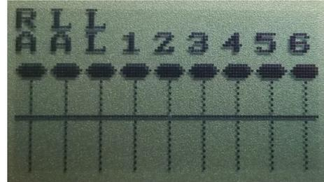
Ein ovaler Indikator, oben in der vertikalen Linie positioniert, bedeutet optimale Qualität und guten Elektrodenkontakt. Für qualitativ hochwertige Aufzeichnungen sollten die Balken die horizontale Linie auf dem Display erreichen oder überschreiten. Ein niedriges Balkendiagramm weist auf einen schlechten Kontakt zwischen Elektrode und Haut und eine hohe Elektrodenimpedanz hin. Die Hautvorbereitung sollte wiederholt und die Elektrode(n) ausgetauscht werden.
