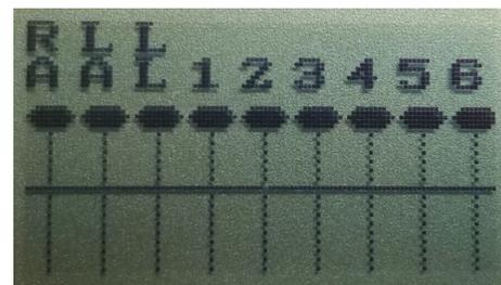
Un indicatore ovale posizionato nella parte alta della linea verticale indica una qualità elevata e un buon contatto dell'elettrodo. Per registrazioni di buona qualità, le barre devono raggiungere o superare la linea orizzontale del display. Una barra bassa indica un contatto scadente tra elettrodo e
