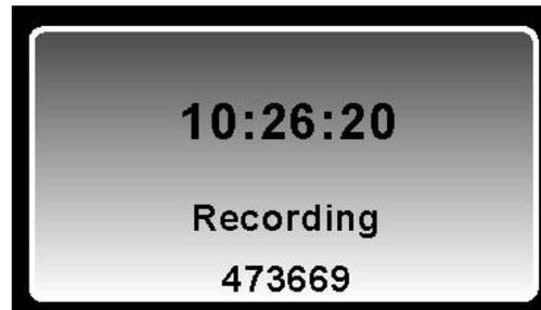
Durante il funzionamento normale di una registrazione standard con l'H12+ per 48 ore, l'ora corrente (HH:MM:SS) viene visualizzata al centro dello schermo per l'intera sessione di registrazione. Le ore totali registrate (da 0 a 48 ore totali) sono visualizzate al di sotto dell'ora corrente. Il messaggio Recording (Registrazione) viene visualizzato al di sotto del numero delle ore totali registrate; il numero dell'ID paziente è visualizzato nella parte bassa dello schermo LCD.
